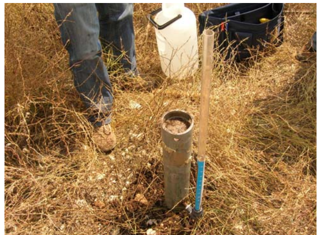
Figura 4.1 – Test infiltrometrico eseguito con il tubo metallico.
