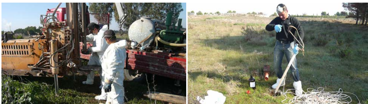
Figura 6.2. Fotografie relative alle procedure di carotaggio (a sinistra) e di campionamento statico dei piezometri (a destra).
