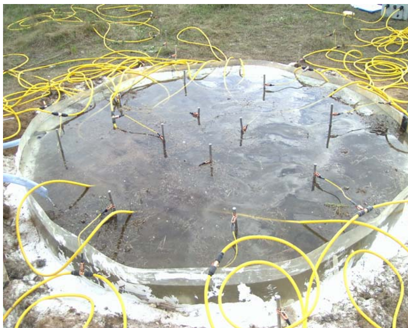
Figura 4.4b – Anello infiltrometrico riempito di acqua durante la prova a carico costante.
