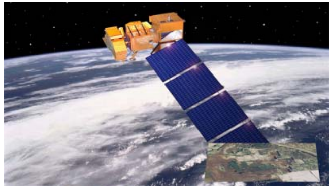
Figura 2.1: Sensore Thematic Mapper, installato a bordo del satellite Landsat ed utilizzato nel programma di eco-diagnosi
